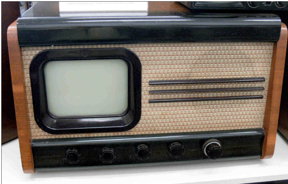
Prvý hromadne vyrábaný československý televízor Tesla 4001A. Vyrábala sa v rokoch 1953 – 1957, umožňoval príjem jediného, pevne nalaďeného TV kanálu, a disponoval kruhovou obrazovkou s priemerom 25 cm s obdĺžnikovým bakelitovým rámkom, foto wikipédia/Wolfgang Sauber.
