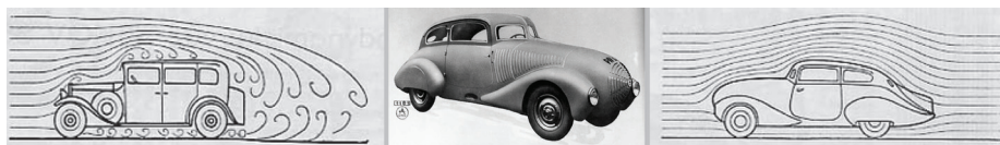
Obr. 5 Vplyv aerodynamiky na obtekanie vzduchu okolo karosérie vozidla 8
