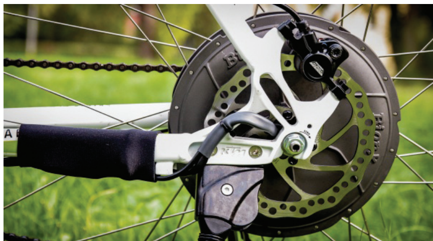
Obr. 19 Elektromotor elektrického bicykla ako súčasť náboja kolesa 23
