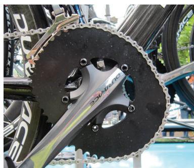
Obr. 10 Asymetrické predné ozubené koleso prevodníka na bicykli 14
