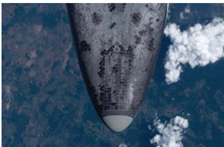
Obr. 14 Tepelný štít raketoplánu zložený z keramických platničiek 13
